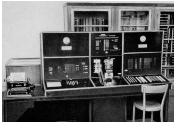
Bild 3: Konrad Zuses Z4 (1944/45) verwendete Lochstreifen.
